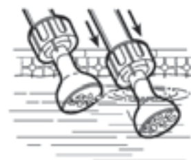
Boquilla de doble uso: para limpiar los residuos del fondo y otra para los de la superficie.
