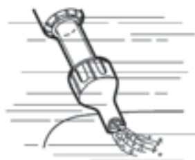
Boquilla de doble uso: para limpiar los residuos del fondo y otra para los de la superficie.
